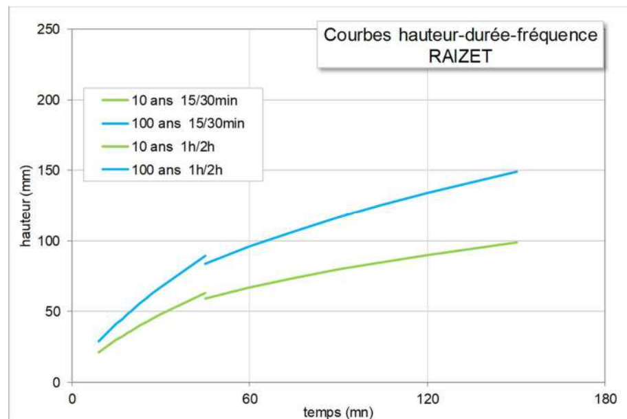
Figure 35 : graphe hauteur-durée-fréquence pour le poste du Raizet
