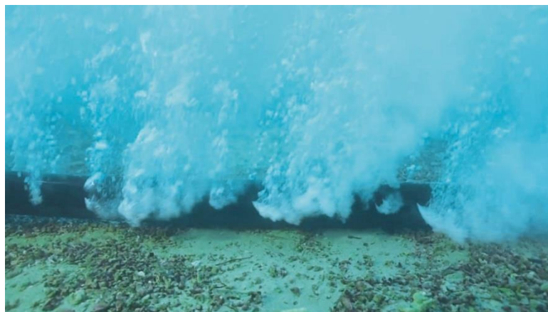
Figure 128 : Visualisation d'un rideau de bulle positionné sur le fond (Source : ENSTA Bretagne)
