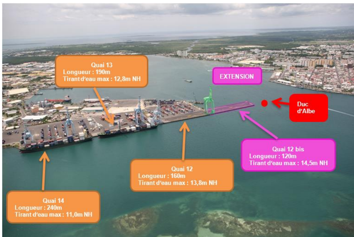
Figure 8 : Illustration de l'extension du quai 12 et des autres quais (Source : GPMG)
