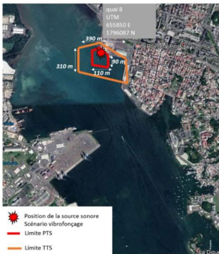
Figure 91 : Limites des seuils PTS et TTS (vibrofonçage au quai 8)
