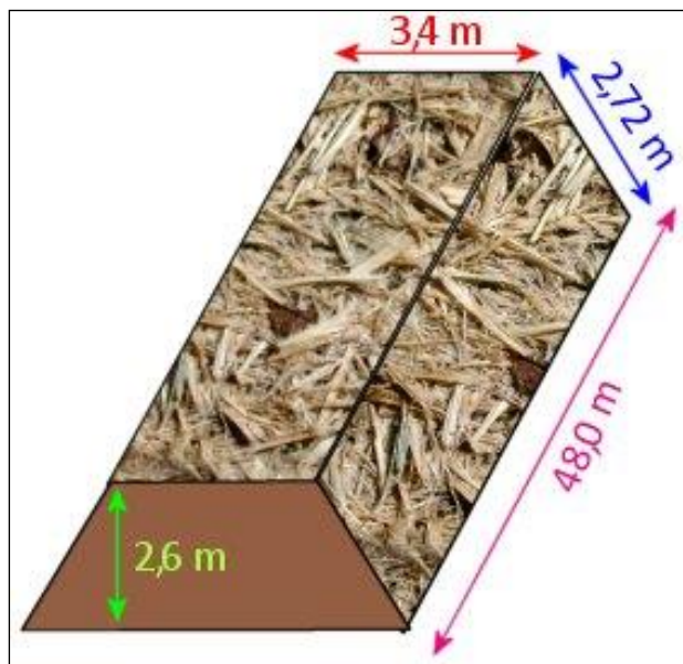
Figure 27: Caractéristiques géométriques d'un andain
