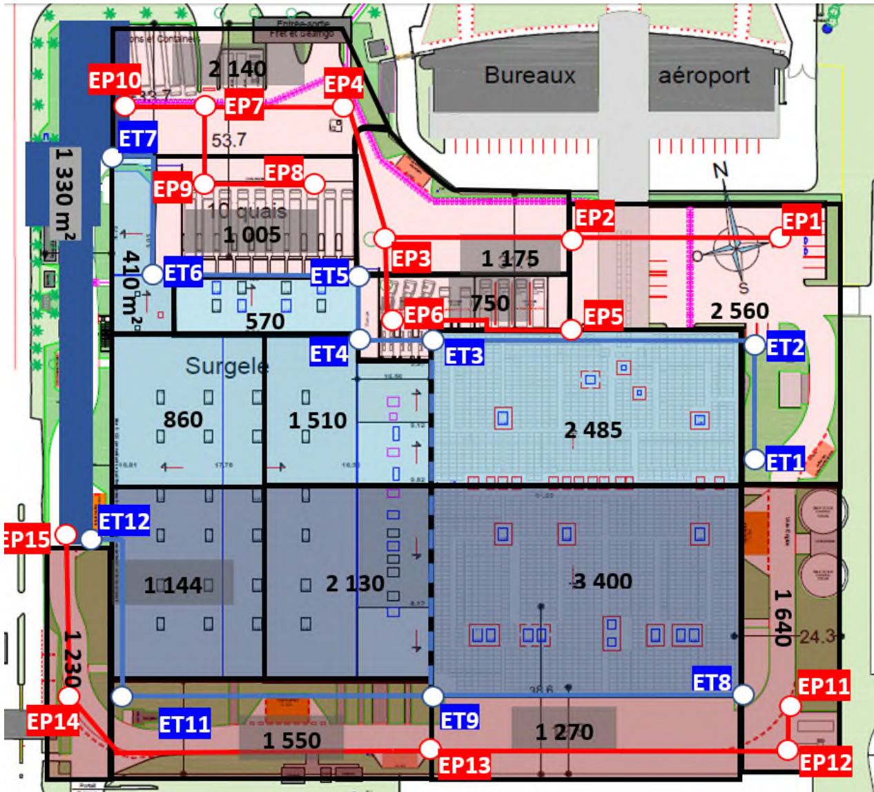
Figure 16 : Représentation du réseau d'évacuation des EP. Les surfaces sont exprimées en m 2
